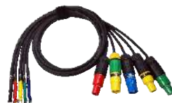
400A国标CAM LOCK电房线-2M 采用1*25 2 -1*120 2 单芯橡胶套软电缆
