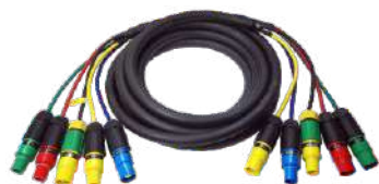
400A国标CAM LOCK延长线(IP67) 采用1*25 2 -1*120 2 单芯橡胶软电缆
