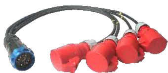
SLY® P19芯 电葫芦散尾(Socapex) 采用1个19芯公插头 4条4*1.5 2 橡胶软电缆;长度1M 4个16A 4P 母连接器 专用4通道电葫芦散尾
