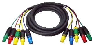
400A国标CAM LOCK延长线(IP67) 采用1*25 2 -1*120 2 单芯橡胶套软电缆
