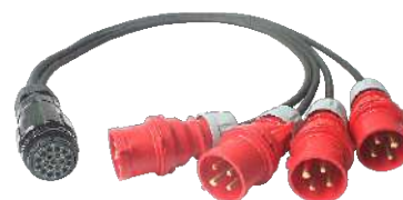
SLY® P19芯 电葫芦转换线(Socapex) 采用1个19芯母连接器 4条4*1.5 2 橡胶软电缆;长度1M 4个16A 4P 公插头 专用4通道电葫芦转换线
