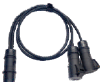
16A-1Y2分线(1M) 1x16A 插头（输入） 1x16A 连接器（输出） 3*2.5 2 柔性电缆
