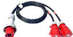
63A-1Y2分线(3M) 1x63A 5芯插头（输入） 2x32A 5芯连接器（输出） 5*6 2 橡胶软电缆
