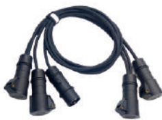
16A-1T4分线(1.5M/2M) 1x16A 插头（输入） 4x16A 连接器（输出） 3*2.5 2 柔性电缆
