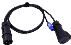
16A-1Y2分线(1M) 1x16A 插头（输入） 1x16A 连接器（输出） 1xpowerCON 20A（输出） 3*2.5 2 柔性电缆
