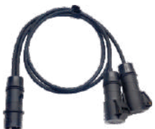
16A-1Y2分线(1M) 1x16A 插头（输入） 2x16A 连接器（输出） 3*2.5 2 柔性电缆
